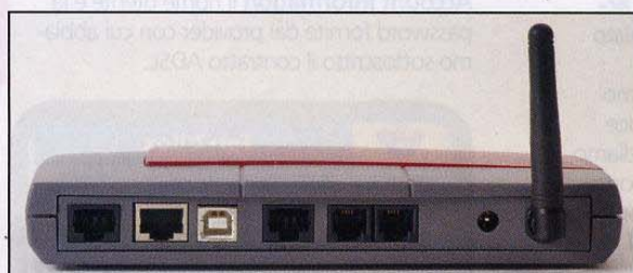
Il retro del FRITZ!Box WLAN è simile a quello del precedente modello: un set di porte per i collegamenti ai PC e uno per la telefonia. Più, naturalmente, l'antennina radio per la connessione senza fili.
